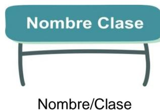
Para el diagrama de clases, una clase es representada mediante un dibujo en forma de rectángulo donde se pueden contemplar tres separaciones; en la primer parte se inserta el nombre de la clase; en la segunda y tercera, se pueden agregar los atributos o bien las operaciones, tal como se muestra en la figura anterior, donde no se insertaron atributos y operaciones, porque no son importantes en esa clase para la comprensión.
