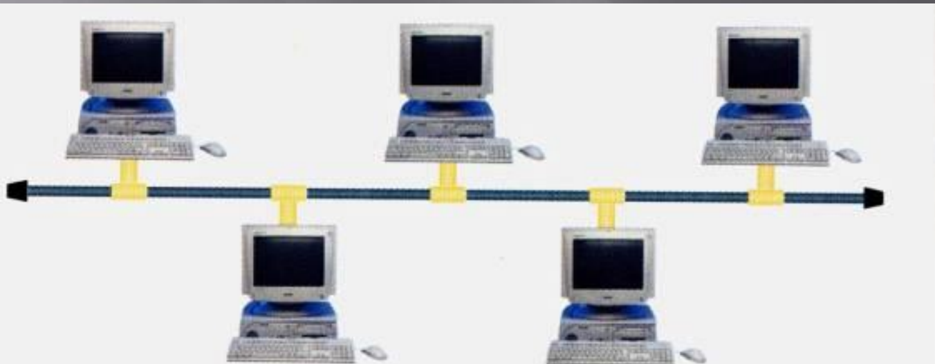
Figura 3. Topología de una red Ethernet en bus.
