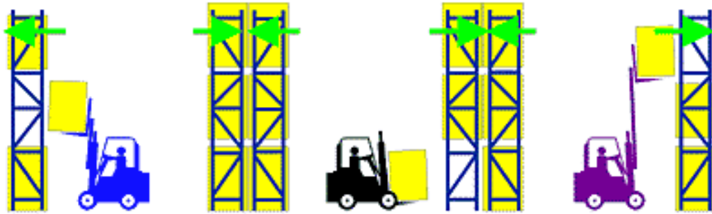
Figura 6. Racks selectivos de doble profundidad (Logistic, 2013).
