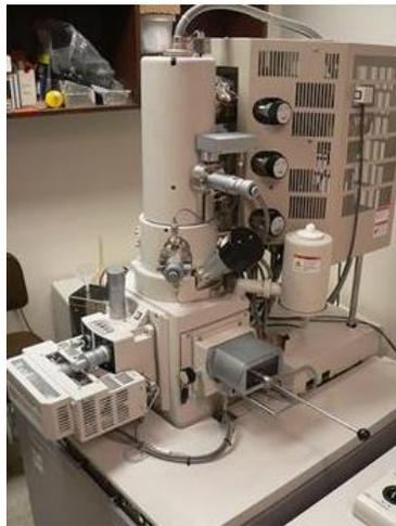
**Figura 13. El microscopio electrónico de barrido.**
