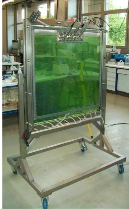
**Figura 28. Fotobiorreactor de capa plana.** Tomado de:
