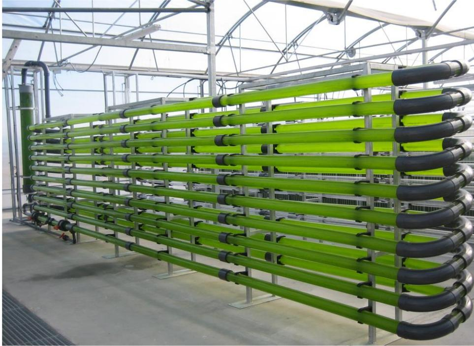
**Figura 24. Fotobiorreactor tubular.** Tomado de:
