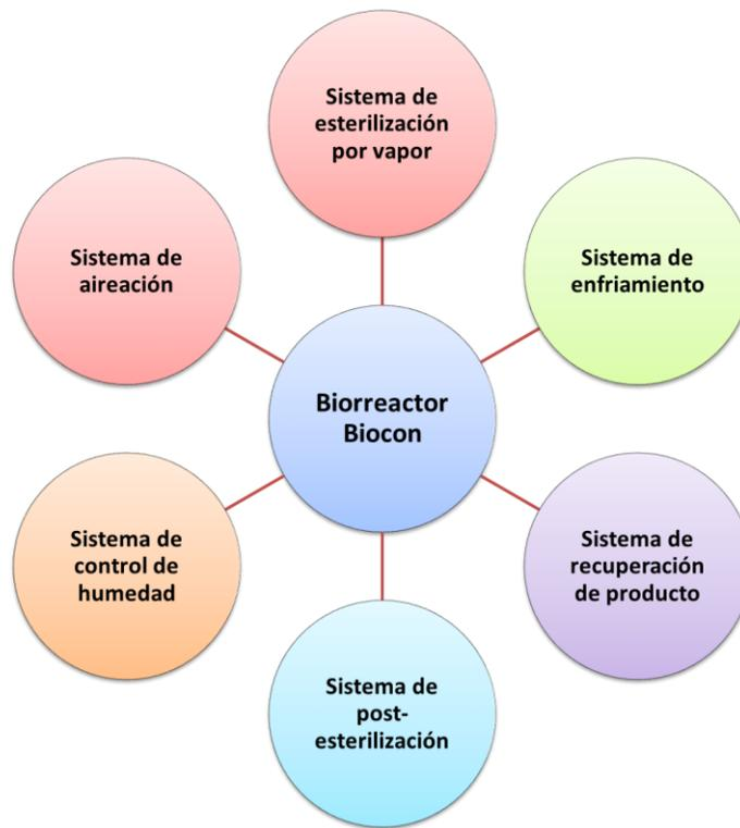
Figura 39. Elemento que posee un biorreactor Biocon.
