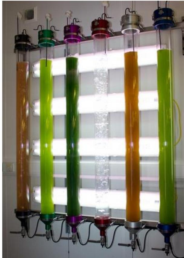
**Figura 25. Fotobiorreactor de columna.** Tomado de:
