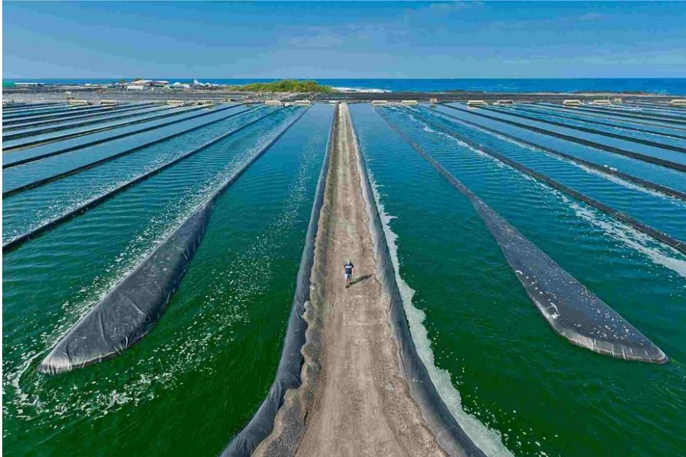
**Figura 23. Fotobiorreactor de estanque abierto.** Tomado de:
