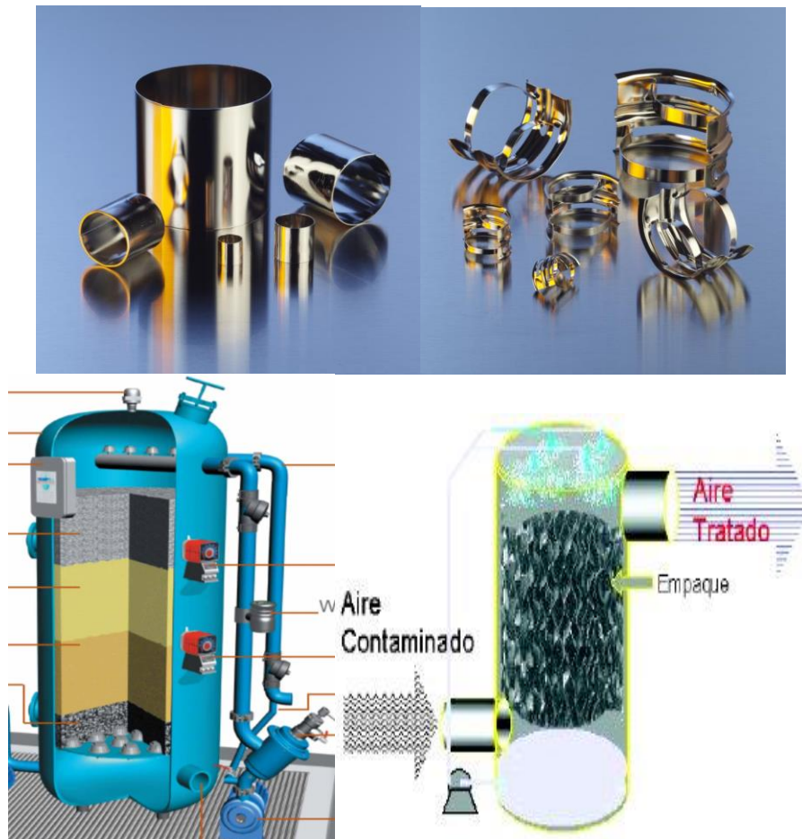
Figura 15. Empaques para columnas de absorción (Revah S.M. 2010).
