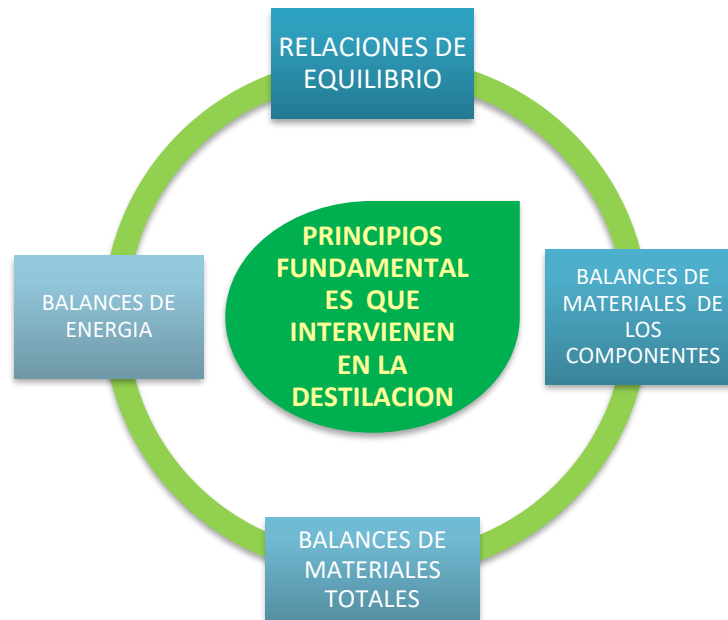
Figura 9. Principios básicos de destilación.
