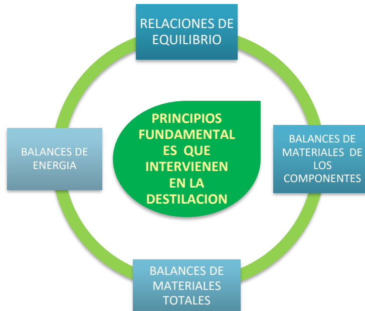
Figura 9. Principios básicos de destilación.
