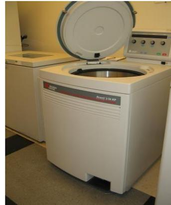
**Figura 6. Botellas y ultracentrífuga.** Se muestra de lado izquierdo botellas para ultracentrífuga con una graduación que permite el manejo exacto de volúmenes y del lado derecho se muestra una ultracentrífuga que puede alcanzar velocidades de hasta 14000 rpm.
