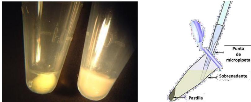
**Figura 8. Producto de la centrifugación.** Del lado izquierdo se muestra la pastilla separada del sobrenadante después de la centrifugación, del lado derecho se esquematiza la forma correcta de extraer el sobrenadante, inclinando el tubo del lado opuesto a donde está adherida la mayor cantidad de la pastilla.
