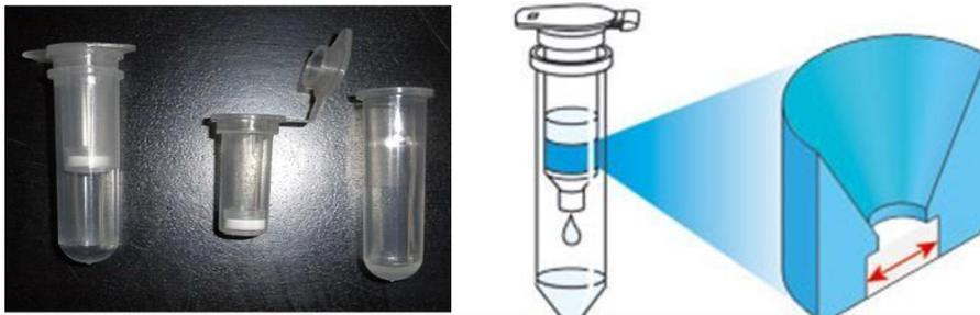
**Figura 11. Columna de sílica para purificar DNA.** El sistema se compone de un tubo eppendorf con fondo redondo y una columna que contiene un filtro de sílica en la que se introduce la muestra a purificar.
