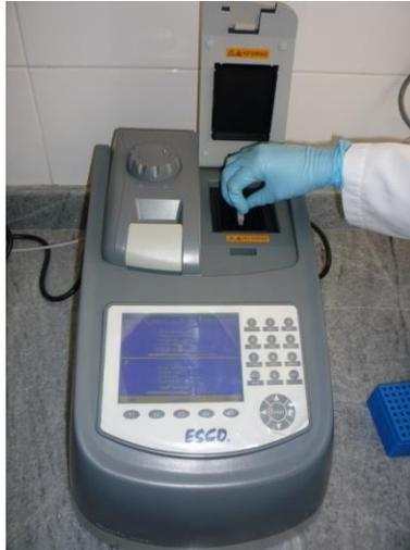
**Figura 13. Termociclador.** Existen muchas marcas y tamaños, sin embargo todos cuentan con una cámara donde se acoplan los tubos para PCR y una tapa que es la que lleva a cabo las fluctuaciones de temperatura, y una pantalla donde uno puede ingresar los ciclos de temperatura y observar el desarrollo de la reacción.
