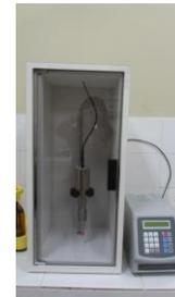
**Figura 7. Instrumentos para disrupción mecánica.** De izquierda a derecha se muestra un mortero, disruptor celular y un sonicador, empleados para romper de forma mecánica la célula.
