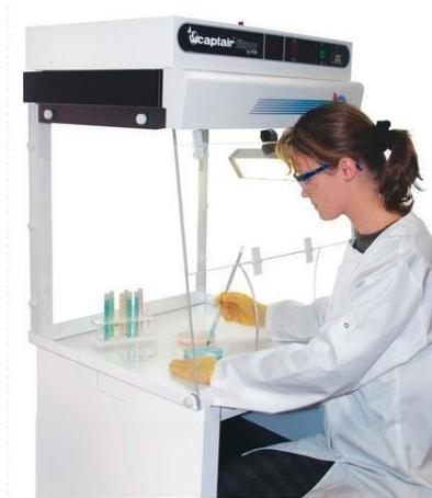
**Figura 3. Campana de flujo laminar.** Se muestra una campana de flujo laminar que permite el trabajo en condiciones asépticas.
