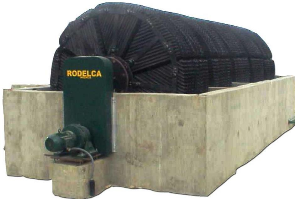
Figura 17. Disco Biologico en Plataforma de Concret.
