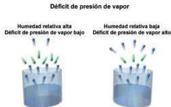
Figura 5. Diferencia de las presiones de vapor que son las que definen la dirección de salida de agua. Fuente: Met Ed.
