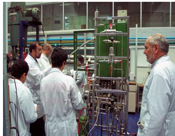
Figura 2. Bioproceso para generación de microalgas oleaginosas. Fuente: UNAM, 2007.
