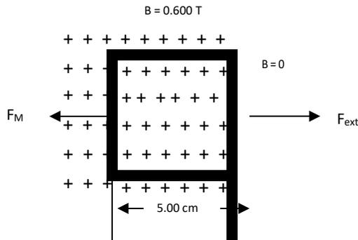
Figura 1.20 Representación esquemática de una bobina cuadrada (ejemplo 7)
