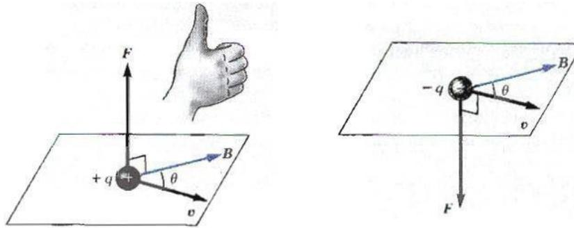
Figura 1.18 Ley de la mano derecha para determinar la dirección de una fuerza magnética
