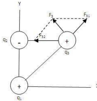
Figura 1.5 Distribución de tres cargas puntuales en el plano xy (ejemplo 2).
