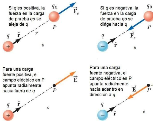
Figura 1.10 Fuerzas y Campos eléctricos experimentados por una carga de prueba.
