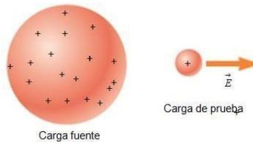
Figura 1.9 Carga de prueba que experimenta un campo eléctrico.
