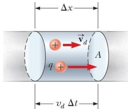
Figura 1.12 Segmento de un conductor uniforme de área transversal  $A$ .
