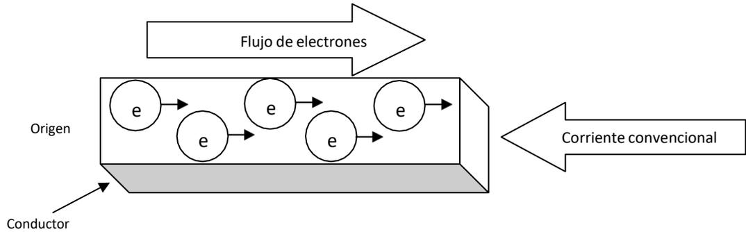
Figura 1.11 Flujo de electrones y corriente convencional en un conductor.
