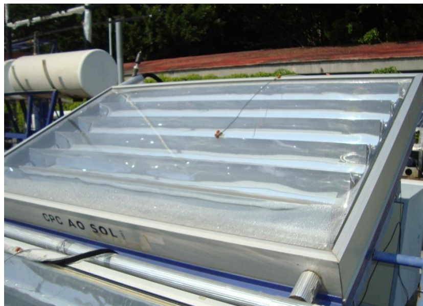
CPC Instalado en el Instituto de Energías Renovables.
