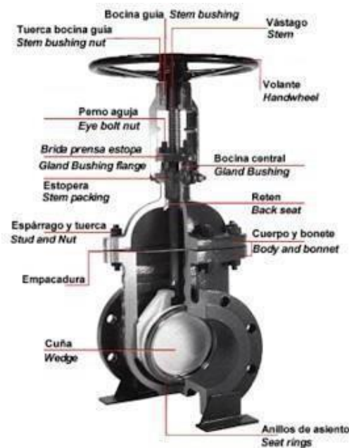
Figura 35. Corte tres cuartos de una válvula de compuerta.
