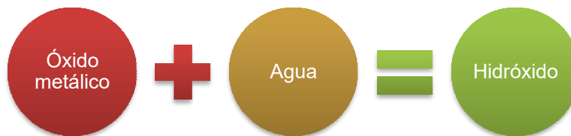
Figura 10. Formación de los hidróxidos. Al combinar agua con un óxido metálico se forma un hidróxido.
