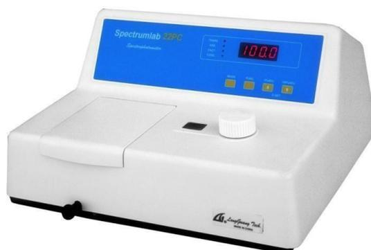
**Figura 7.** Espectrofotómetro UV-visible.
