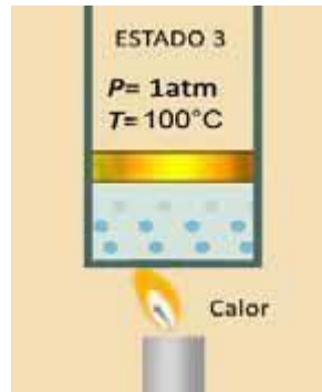
Figura 4. Desplazamiento del émbolo por cambio de volumen.
