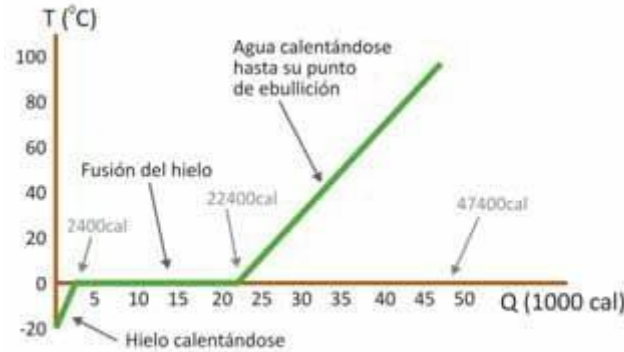
Figura 5. Calor sensible y calor latente.
