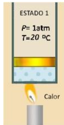
Figura 2. Émbolo a presión constante.
