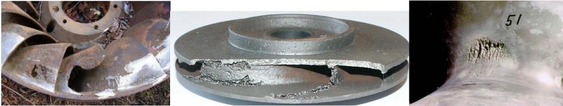
Figura 18. Daños por la cavitación en una turbina Francis, Bomba centrífuga y turbina Kaplan.
