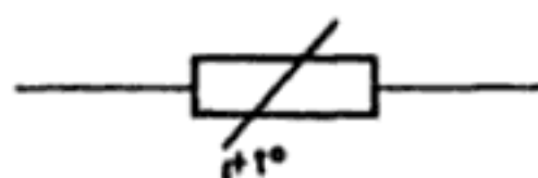
Figura 2.12 Símbolo para una resistencia con dependencia intrínseca de la temperatura y variación lineal (Publicación CEI 117-6).
