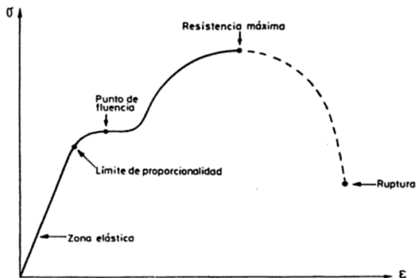
Figura 2.7 Relación entre esfuerzos y deformaciones. La escala de la zona elástica está muy ampliada.
