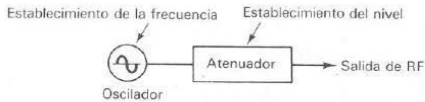
Figura 8-1. Diagrama de bloques de un generador de onda senoidal básico.
