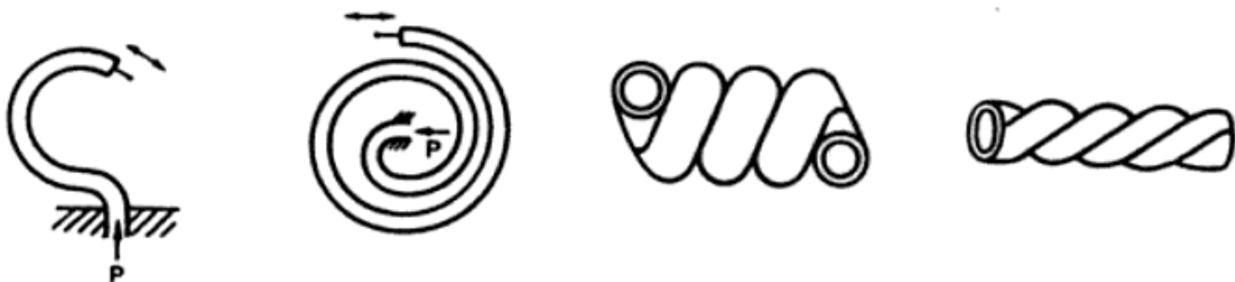
Figura 1.13 Distintas formas de los tubos Bourdon.
