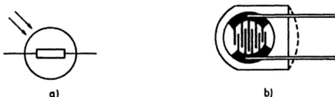
Figura 2.23 Fotorresistencia (LDR). a) Símbolo (Publicación CEI 117-7). b) Modelo de bajo coste encapsulado en plástico transparente (Documentación Philips).
