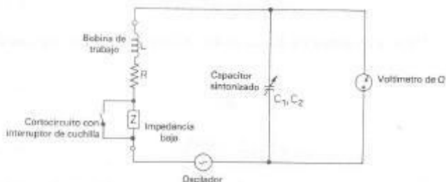
Figura 6-31. Determinación con medidor de Q de componente de baja impedancia en la conexión en serie.
