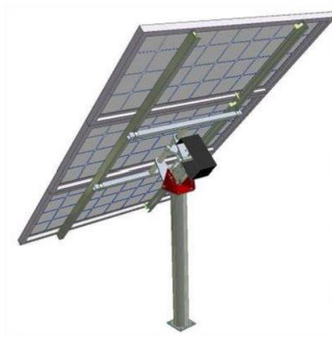
a) Seguidor solar de un eje
