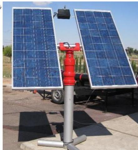
b) Seguidor solar de dos ejes
