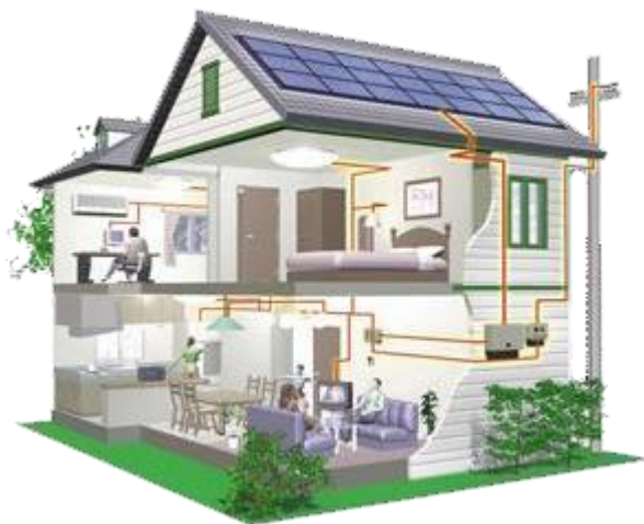
Sistema fotovoltaico interconectado a la red para uso residencial.
