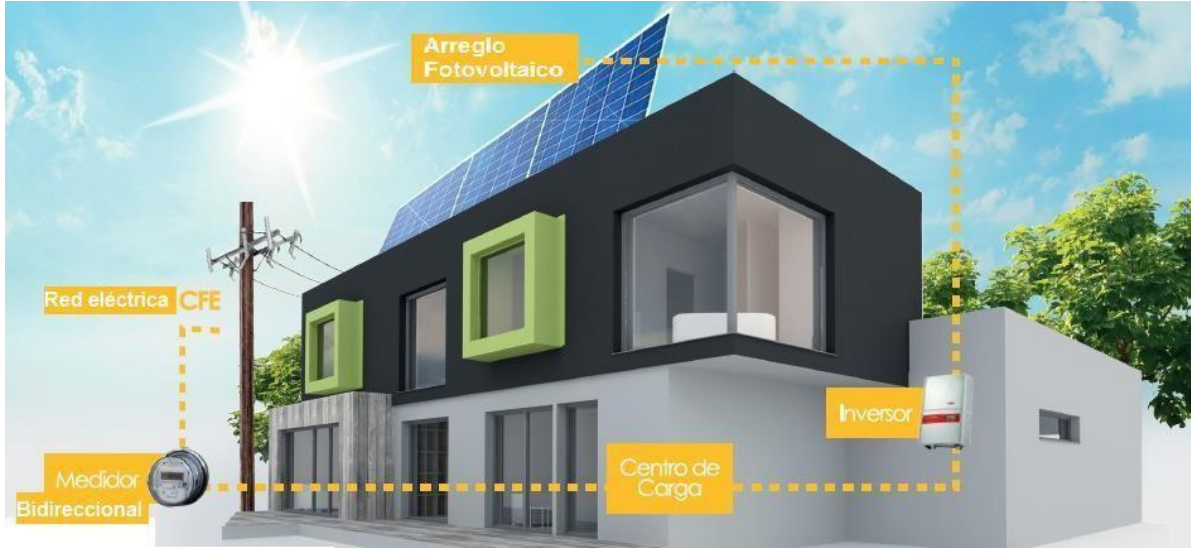
Configuración típica de un sistema fotovoltaico interconectado a la red.
